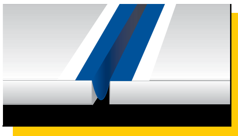
Colocación en omega de Mapeband en el interior de la junta de dilatación
